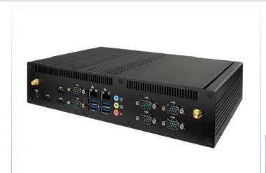
СПАРКС JW793 - Малогабаритные промышленный ПК СПАРКС с пассивным охлаждением может использоваться для встраиваемых компьютерных комплексов (банкоматы, платежные терминалы и т.п.), а также для мобильных бортовых систем. Решения СПАРКС являются высокопроизводительными компьютерами с пониженным энергопотреблением, широким диапазоном напряжения электропитания, а также предусмотрены различные возможности монтажа корпуса устройства. Для каждой модели предлагается несколько базовых конфигураций.
