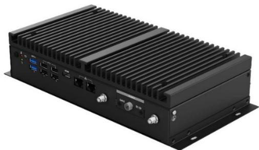
Встраиваемые промышленные мини ПК СПАРКС разработаны с учетом возможности работы в запыленных помещениях, в производственных цехах, могут быть установлены на транспортные средства и обеспечивать режим работы «24 на 7». Промышленные ПК СПАРКС имеют пассивное охлаждение и обладают широким набором дополнительных опций: возможна установка дополнительных плат для увеличения стандартного набора портов ввода-вывода, возможно размещение модулей для обеспечения беспроводной связи.
